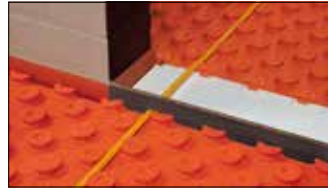
Schlüter®-DILEX-DFP ist ein Dehnungsprofil mit Klebefuß zum Einbau im Türbereich oder zur Unterteilung von Estrichflächen. (Produktdatenblatt 9.1)
