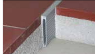
Schlüter®-DILEX-MOP ist ein Dehnungsprofil mit stabilen gezahnten Seitenwänden aus Hart-PVC-Regenerat und einer zwischen den Seitenwänden liegenden Dehnzone aus grauem Weich-Kunststoff für den Einbau bei Mörtelverlegung. (Produktdatenblatt 4.4)
