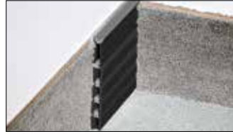
Schlüter®-DILEX-EZ 70 ist ein Entspannungs- und Zierprofil mit hinterschnittenen Seitenwänden aus Hart-PVC, mit einer Dehnungszone aus Weich-Kunststoff für den Einbau bei Mörtelverlegung. Die Verlängerungssegmente können entsprechend der Konstruktionshöhe abgetrennt werden. (Produktdatenblatt 4.2)
