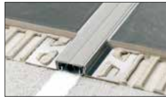
Schlüter®-DILEX-KSBT ist ein Bautrennfugenprofil mit Kantenschutz, bestehend aus seitlichen Befestigungsschenkeln aus Aluminium oder Edelstahl, die mit einer 20 oder 30 mm breiten Bewegungszone aus weichem Kunststoff verbunden sind. (Produktdatenblatt 4.19)
