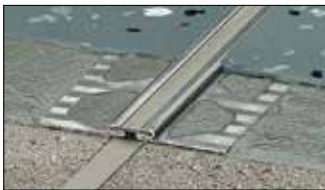
Schlüter®-DILEX-EKSB ist ein Bewegungsprofil mit Kantenschutz für Beschichtungen und sonstige dünn-schichtige Bodenbeläge. Es besteht aus seitlichen Befestigungsschenkeln aus Edelstahl, die mit einer nichtauswechselbaren Dehnzone aus weichem Kunststoff verbunden sind. (Produktdatenblatt 4.8)
