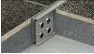
Schlüter®-DILEX-EMP ist ein Bewegungsprofil aus Edelstahl für die Mörtelbetverlegung, welches durch eine Nut- / Federverbindung horizontale Bewegungen aufnehmen kann. (Produktdatenblatt 4.17)
