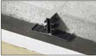
Schlüter®-DILEX-EP ist ein Bewegungsprofil für die Verarbeitung in schwimmenden oder Verbund-Estrichen. Die Seitenteile bestehen aus Hart-PVC mit einer unteren und oberen Bewegungszone aus grauem Weich-Kunststoff. (Produktdatenblatt 4.5)
