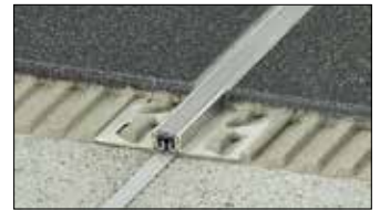
Schlüter®-DILEX-KS ist ein Bewegungsprofil mit Kantenschutz, bestehend aus seitlichen Befestigungsschenkeln aus Aluminium oder Edelstahl, die mit einer auswechselbaren Dehnzone aus weichem Kunststoff verbunden sind. (Produktdatenblatt 4.8)
