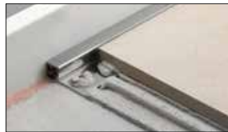
Schlüter®-DILEX-KSA ist ein Anschlussprofil mit Kantenschutz, bestehend aus einem seitlichen Befestigungsschenkel aus Aluminium oder Edelstahl, der mit einer auswechselbaren Dehnzone aus weichem Kunststoff verbunden ist. Es dient zum Anschluss von Belagsflächen an feste Einbauteile wie z. B. Fensterelemente. (Produktdatenblatt 4.8)
