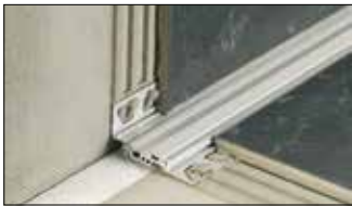
Schlüter®-DILEX-BTO ist ein Bautrennfugenprofil aus Aluminium für Boden-/Wandübergänge. Durch die seitliche Gelenkanbindung des ineinander verschiebbaren Mittelteils ist eine dreidimensionale Bewegungsaufnahme möglich. (Produktdatenblatt 4.20)
