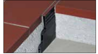
Schlüter®-DILEX-MP ist ein Dehnungsprofil mit hinterschnittenen Seitenwänden aus Hart-PVC-Regenerat und einer die Seitenwände überdeckenden Dehnzone aus Weich-Kunststoff mit Verlängerungsprofilen für den Einbau bei Mörtelverlegung. (Produktdatenblatt 4.3)
