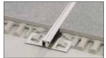
Schlüter®-DILEX-EDP ist ein Bewegungsprofil aus Edelstahl, welches durch eine Nut- und Federverbindung horizontale Bewegungen aufnehmen kann. (Produktdatenblatt 4.16)
