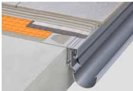
Schlüter-BARA-RTK ist ein Randprofil mit Tropfkante zur Verlegung auf einen fertigen Gefälleestrich. Das Profil hat eine Aufnahmevorrichtung zur Befestigung des Rinnensystems Schlüter-BARIN. Die Fliesen können mit Überstand verlegt werden. Alternativ kann auf dem vertieften Übergang zur Tropfkante ein Schlüter-JOLLY als Abschluss der Fliesenkante aufgebracht werden. (Produktdatenblatt 5.9)
