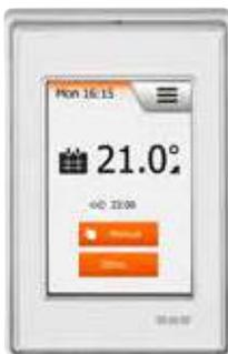
Schlüter-DITRA-HEAT-E-R3 ist ein Temperaturregler für die Regelung der mit Schlüter-DITRA-HEAT-E elektrisch beheizten Boden- und Wandbeläge. Die Bedienung erfolgt über das 3,5" (8,9 cm) große Touchscreen-Display. Der Temperaturregler steuert wahlweise die Oberflächen- oder Raumtemperatur nach einem Zeitplan. Ein Reservefühler ist im Lieferumfang enthalten. (Produktdatenblatt 6.4)
