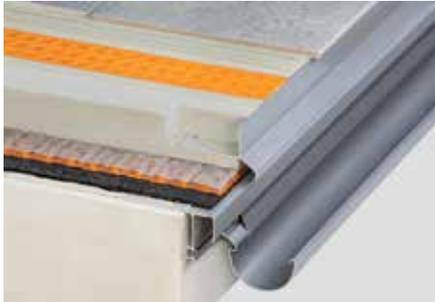
Schlüter-BARA-RK ist ein T-förmiges Abschlussprofil. Der vordere Abschlusschenkel hat einen vorgezogenen Abtropfschenkel, der die Fuge zur TROBA-Flächen-drainage überdeckt.
