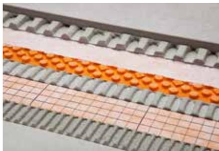
Schlüter-DITRA-DRAIN 4 ist eine formstabile Polyethylenfolie mit einer einseitig ausgeformten speziellen Noppenstruktur und einem an der Oberseite aufkaschierten Filtervlies aus Polypropylen. Sie ist ein universeller Untergrund für Fliesenbeläge als Entkopplungsschicht und dauerhaft wirksame kapillarpassive Verbunddrainage.
