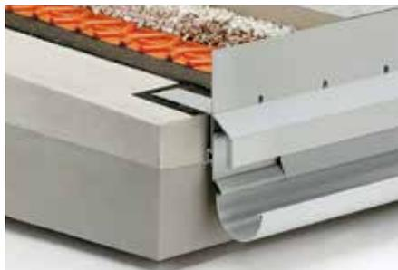
Schlüter-BARA-RKLT ist ein winkelförmiges Randprofil mit Entwässerungslöchern aus farbig beschichtetem Aluminium. Es eignet sich für großformatige Plattenelemente, die wahlweise auf ungebundene Kies-/Splittschüttungen oder auf Stelzlager verlegt werden. BARA-RKLT besitzt eine T-förmige Profilkammer zur Befestigung des Rinnensystems Schlüter-BARIN.
