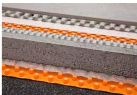
Schlüter-TROBA-PLUS ist eine dauerhaft wirksame kapillarbrechende Flächendrainage, die anfallendes Wasser sicher abführt. Die engstehenden als Kegelstumpf ausgebildeten Noppen sind hochbelastbar und mit einem aufkaschierten wasserdurchlässigen Vlies überdeckt. Diese stellen den Belag ganzflächig auf und bilden so einen durchgängigen Drainageraum.
