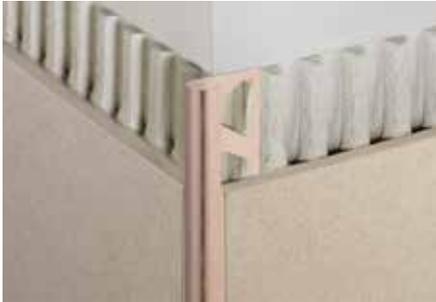
Schlüter-RODEC-A eloxiert ist ein symmetrisch gerundetes Profil mit Fugensteg für Wandaußenecken und Belagsabschlüsse aus Aluminium mit unterschiedlich eloxierten Oberflächen. Durch den Fugensteg wird eine definierte Fugenkammer zur Fliese vorgegeben.
