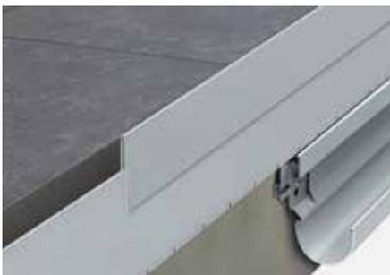
Schlüter-BARA-RHA ist ein höhenverstellbares Abdeckprofil aus farbig beschichtetem Aluminium. In Verbindung mit entsprechenden BARA-Trägerprofilen, z. B. BARA-RWL oder BARA-RKL, dient es zur Begrenzung der freien Randbereiche an Balkonen und Terrassen. Hiermit kann eine Abdeckung von Aufbauten bis zu 220 mm individuell realisiert werden.
