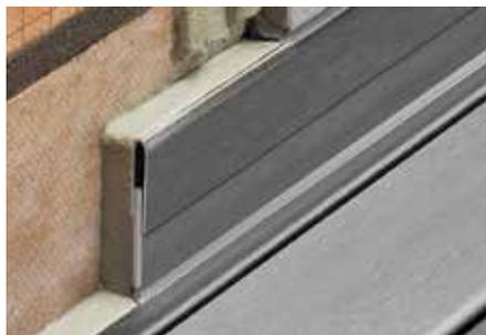
Schlüter-SHOWERPROFILE-R ist ein zwei-teiliges Wandanschlussprofil zur Verkleidung des gefällebedingt frei bleibenden Wandbereichs an einer Linientwässerung. Das Profil ist in strukturbeschichtetem oder gebürstetem Edelstahl erhältlich. Es ist an der Rückseite mit einem Vlies zur Verankerung im Fliesenkleber ausgestattet. Durch den zwei-teiligen Aufbau kann SHOWERPROFILE-R in einem Bereich von ca. 23 bis 45 mm (in zwei Ausführungen) stufenlos in der Höhe angepasst werden.
