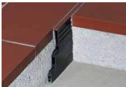
Schlüter-DILEX-MP ist ein Dehnfugenprofil mit hinterschnittenen Seitenwänden aus Hart-PVC-Regenerat und einer die Seitenwände überdeckenden Dehnzone aus Weich-Kunststoff mit Verlängerungsprofilen für den Einbau bei Mörtelverlegung.
