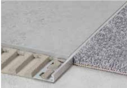
Schlüter-SCHIENE-A ist ein dekoratives Profil aus Aluminium, das in unterschiedlich eloxierten und veredelten Oberflächen erhältlich ist. Sein Abschlusschenkel im 87°-Winkel schützt die Fliesen sicher vor mechanischer Beschädigung. Durch den Fugenstieg wird eine definierte Fugenkammer zur Fliese vorgegeben.
