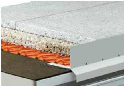
Schlüter-BARA-RKL ist ein winkelförmiges Randprofil mit Entwässerungslöchern aus farbig beschichtetem Aluminium. Es eignet sich für großformatige Plattenelemente, die wahlweise auf ungebundene Kies-/Splittschüttungen oder auf Stelzlager verlegt werden.
