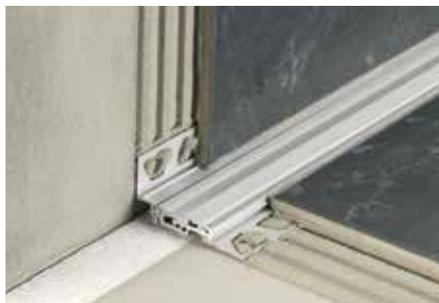
Schlüter-DILEX-BTO ist ein Bautrennfugenprofil aus Aluminium für Boden-/Wandübergänge. Durch die seitliche Gelenkanbindung des ineinander verschiebbaren Mittelteils ist eine dreidimensionale Bewegungsaufnahme möglich.
