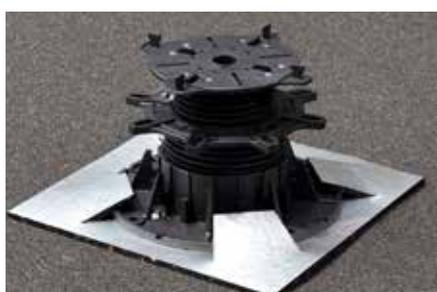
Schlüter-TROBA-LEVEL-PLS 6 sind Pads aus Gummigranulat zum Schutz der Abdichtung. Der Plattenlagerfuß von TROBA-LEVEL-PLV 60 bzw. TROBA-LEVEL-LV 3 ist in den Einschlitzungen der Schutzpads TROBA-LEVEL-PLS 6 (6 mm) zu fixieren. Bei PVC-Abdichtungen ist die Alu-Trennlage der Schutzpads nach unten zu verlegen. Bei Verwendung von TROBA-LEVEL-PL 10 sind diese mittig der Pads zu platzieren.
