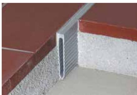
Schlüter-DILEX-MOP ist ein Dehnfugenprofil mit stabilen gezahnten Seitenwänden aus Hart-PVC-Regenerat und einer zwischen den Seitenwänden liegenden Dehnzone aus grauem Weich-Kunststoff für den Einbau bei Mörtelverlegung.
