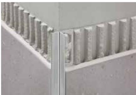
Schlüter-INDEC ist ein hochwertiges Abschlussprofil aus eloxiertem Aluminium für Wandaußenecken und Abschlüsse von Fliesenbelägen. Die Sichtfläche des Profils bildet einen zurückspringenden Zierfalz. (Produktdatenblatt 2.12)
