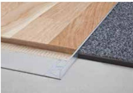
Schlüter-SCHIENE-V ist ein Abschlussprofil für Holzbeläge oder andere formstabile Belagsmaterialien wie Terrazzo-beschichtungen mit rechtwinkligem Übergang vom Befestigungs- zum Abschluss-schenkel. Der gleichmäßig geformte Abschluss-schenkel ermöglicht das Abschleifen des Belags.
