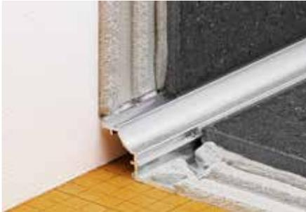
Schlüter-DILEX-AHK ist ein aus Aluminium gefertigtes Hohlkehprofil für Wandinnenecken, Küchenarbeitsplatten oder Ablagen, die einen keramischen Belag erhalten. Es ist in verschiedenen eloxierten Oberflächen oder farbig beschichtetem Aluminium erhältlich. (Produktdatenblatt 4.21)
