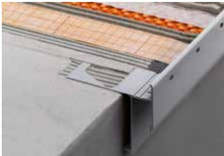
Schlüter-BARA-RAKE ist ein Randprofil mit Tropfkante zur Verlegung auf einen fertigen Gefälleestrich. Das Profil BARA-RAKE ist besonders gut für den Konstruktionsaufbau mit der Verbunddrainage Schlüter-DITRA-DRAIN geeignet. Durch die gelochte Aufkantung erhält man einen sauberen Fliesenabschluss.
