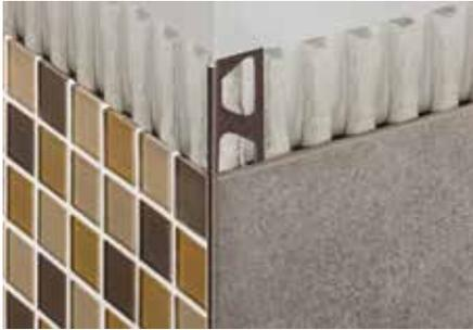
Schlüter-FINEC-TS ist ein hochwertiges Abschlussprofil aus strukturbeschichtetem Aluminium für die Außenkanten von Fliesenbelägen, Glasmosaiken oder Putz-/Spachteloberflächen. Das Profil schützt den Belagsrand vor mechanischen Schäden und bildet eine elegante, schmale Eckausprägung. (Produktdatenblatt 2.17)
