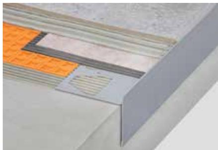
Schlüter-BARA-RT ist ein T-förmiges Randprofil aus farbig beschichtetem Aluminium zur Begrenzung der freien Randbereiche an Balkonen und Terrassen. Der obere Abschlusschenkel deckt die Belagskante ab, der untere bildet eine Tropfkante und verdeckt eventuell die Fuge zur TROBA-Flächendrainage.
