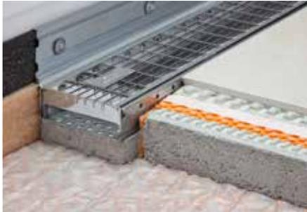
Schlüter-TROBA-LINE-TLR-E ist eine Drainagerinne mit einem oberen Drainagerost aus poliertem Edelstahl, die bei niedrigen Anschlusshöhen zu Türelementen auf Balkonen und Terrassen eingebaut werden kann, um aufstauendes Wasser zu verhindern. Ebenso kann sie als höher belastbare Flächendrainagerinne verwendet werden. (Produktdatenblatt 7.4)
