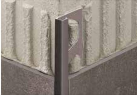
Schlüter-QUADEC-TS ist ein hochwertiges Abschlussprofil aus Aluminium mit einer speziell strukturierten Beschichtung für Wandaußenecken und Abschlüsse von Fliesenbelägen. Die Sichtfläche des Profils bildet eine rechtwinklige Ausprägung der Außenecke. Durch den Fugensteg wird eine definierte Fugenkammer zur Fliese vorgegeben. (Produktdatenblatt 2.10)
