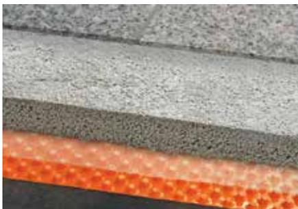
Schlüter-TROBA-PLUS-G ist eine dauerhaft wirksame kapillarbrechende Flächendrainage, die anfallendes Wasser sicher abführt. Die entstehenden als Kegelstumpf ausgebildeten Noppen sind hochbelastbar und mit einem aufkaschierten wasserdurchlässigen Gittergewebe überdeckt. Sie stellen den Belag ganzflächig auf und bilden so einen durchgängigen Drainageraum. Schlüter-TROBA-PLUS 8G ist besonders gut für die Kombination mit Drainageestrichen geeignet. (Produktdatenblatt 7.2)
