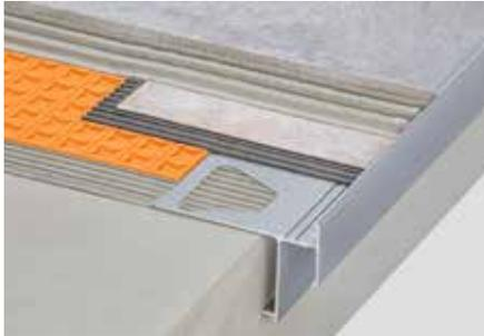
Schlüter-BARA-RAKEG ist ein Randprofil mit Tropfkante zur Verlegung auf einen fertigen Gefälleestrich. Es ist für den Konstruktionsaufbau mit der Verbundkopplung Schlüter-DITRA ausgelegt. Durch die geschlossene Aufkantung erhält man einen sauberen Fliesenabschluss.
