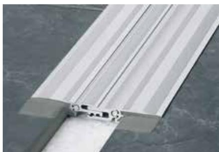
Schlüter-DILEX-BTS ist ein Bautrennfugenprofil aus Aluminium für den nachträglichen Einbau in fertige Belagsflächen. Durch die seitliche Gelenkanbindung des ineinander verschiebbaren Mittelteils ist eine dreidimensionale Bewegungsaufnahme möglich.
