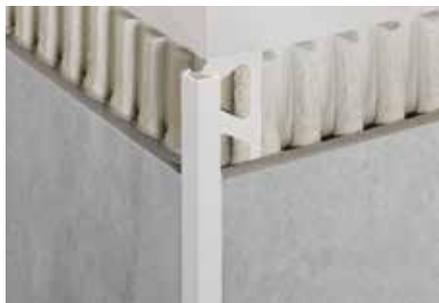
Schlüter-QUADEC-PQ ist ein Abschlussprofil aus farbigem PVC für Wandaußenecken und Abschlüsse an Fliesenbelägen. Die Sichtfläche des Profils bildet eine rechteckige Ausprägung der Außenecke. Durch den Fugensteg wird eine definierte Fugenkammer zur Fliese vorgegeben.
