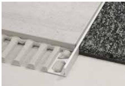
Schlüter-SCHIENE ist ein spezielles Profil zum Abschluss der Außenkanten an Fliesenbelägen, lässt sich aber auch für andere Belagsmaterialien und Anwendungen sehr gut einsetzen. Durch den Fugensteg wird eine definierte Fugenkammer zur Fliese vorgegeben. Schlüter-SCHIENE-E hat keinen Fugensteg.
