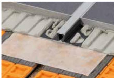
Schlüter-DILEX-BWB ist ein Bewegungsfugenprofil mit Seitenteilen aus Hart-PVC-Regenerat. Die obere Bewegungszone besteht aus weichem Kunststoff und bildet die 10 mm breite Sichtfläche.
