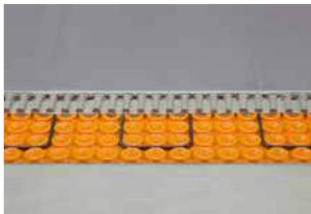
Schlüter-DITRA-HEAT-PS ist eine Polypropylenbahn mit hinterschnittener Noppensstruktur, die rückseitig mit selbstklebendem Trägervlies versehen ist. Nach Abziehen der Schutzfolie kann DITRA-HEAT-PS auf geeigneten Untergründen ohne Verwendung von Fliesenkleber verlegt werden. Die Matte ist wasserundurchlässig und dient zur Aufnahme von Heizkabeln, zur Entkopplung sowie als Dampfdruckausgleichsschicht. (Produktdatenblatt 6.5)
