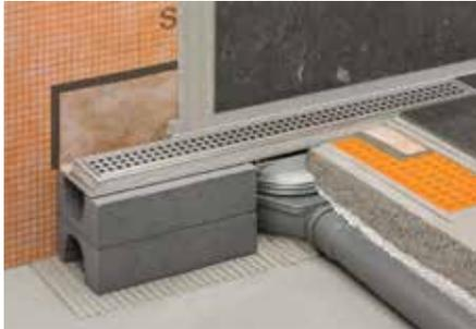
Schlüter-KERDI-LINE-H 50 G2 ist ein komplettes Set für lineare bodenebene Duschen mit einem horizontalen Ablauf. Es ist universell für den zentralen Einbau in einer Fläche oder im Wandbereich einsetzbar und verfügt gemäß DIN EN 1253 über eine Ablaufleistung  $\geq 0,8$  l/s sowie eine Sperrwasserhöhe der Geruchsverschlusseinheit von 50 mm. Zum sicheren Anschluss an die Verbundabdichtung ist auf dem Klebeflansch des Rinnenkörpers werkseitig eine Manschette aus Schlüter-KERDI fest verklebt.
