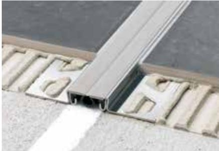
Schlüter-DILEX-KSBT ist ein Bautrennfugenprofil mit Kantenschutz, bestehend aus seitlichen Befestigungsschenkeln aus Aluminium oder Edelstahl, die mit einer 20 oder 30 mm breiten Bewegungszone aus weichem Kunststoff verbunden sind.
