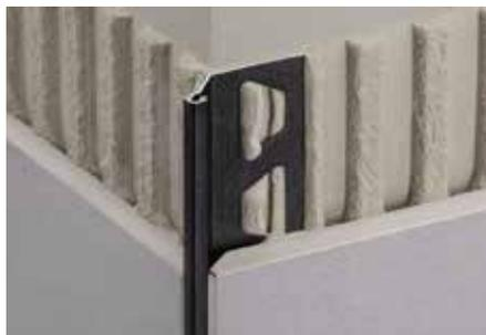
Schlüter-FINEC-SQ ist ein hochwertiges Abschlussprofil aus eloxiertem, farbig oder strukturbeschichtetem Aluminium für die Außenkanten von Fliesenbelägen. Das Profil schützt den Belagsrand vor mechanischen Schäden und bildet eine elegante, schmale, quadratische Eckausprägung. (Produktdatenblatt 2.17)
