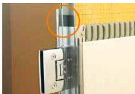
Schlüter-KERDI-BOARD-ZFP ist ein Flachprofil aus Kunststoff, welches zur Verstärkung in dem U-Profil hinterklebt wird. Es dient zum besseren Halt der Befestigungsschrauben von Beschlägen.
