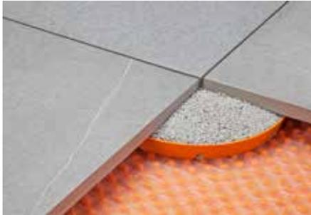
Schlüter-TROBA-STELZ-MR sind Kunststoffringe, die als Verlegehilfe für großformatige Plattenelemente auf Balkonen und Terrassen dienen. Die 25 mm hohen Kunststoffringe werden an den Fugenkreuzungspunkten der Plattenelemente mit Mörtel ausgefüllt, worauf dann die Plattenelemente verlegt werden. (Produktdatenblatt 7.3)
