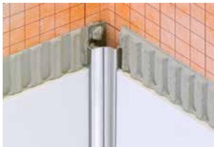
Schlüter-DILEX-HKU ist ein komplett aus Edelstahl gefertigtes Hohlkehprofil für hygienisch anspruchsvolle Wandinnenecken und Boden-/Wandanschlüsse. Durch den innenliegenden Befestigungsschenkel kann das Profil variabel für verschiedene Belagstärken verwendet werden.
