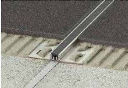
Schlüter-DILEX-KS ist ein Bewegungsfugenprofil mit Kantenschutz, bestehend aus seitlichen Befestigungsschenkeln aus Aluminium oder Edelstahl, die mit einer auswechselbaren Dehnzone aus weichem Kunststoff verbunden sind.
