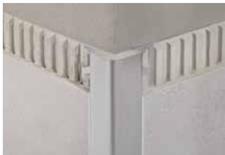
Schlüter-ECK-E ist ein Edelstahl-Eckprofil für Wandaußenecken an Fliesenbelägen und bietet einen stabilen Kantenschutz. Die gelochten Befestigungsschenkel werden bei der Fliesenverlegung in den Fliesenkleber eingebettet.
