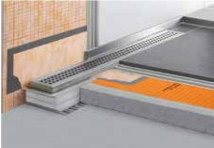
Schlüter-KERDI-LINE-V 50 G2 ist ein komplettes Set für lineare bodenebene Duschen mit einem vertikalen Ablauf. Es ist universell für den zentralen Einbau in einer Fläche oder im Wandbereich einsetzbar und verfügt gemäß DIN EN 1253 über eine Ablaufleistung von  $\geq 0,8$  l/s und eine Sperrwasserhöhe der Geruchsverschlusseinheit von 50 mm. Zum sicheren Anschluss an die Verbundabdichtung ist auf dem Klebeflansch des Rinnenkörpers werkseitig eine Manschette aus Schlüter-KERDI fest verklebt.
