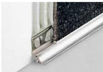
Schlüter-DILEX-AHKA ist ein aus Aluminium gefertigtes Hohlkehprofil für Wandinnenecken, Küchenarbeitsplatten oder Ablagen, die einen keramischen Belag erhalten. Es ist in verschiedenen eloxierten Oberflächen oder farbig beschichtetem Aluminium erhältlich und kann einseitig an vorhandene Beläge angeschlossen werden.
