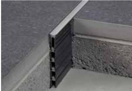
Schlüter-DILEX-EZ 70 ist ein Entspannungs- und Zierprofil mit hinterschnittenen Seitenwänden aus Hart-PVC, mit einer Dehnungszone aus Weich-Kunststoff für den Einbau bei Mörtelverlegung. Die Verlängerungssegmente können entsprechend der Konstruktionshöhe abgetrennt werden.
