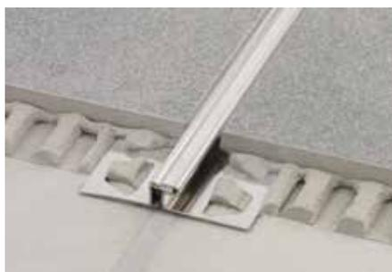
Schlüter-DILEX-EDP ist ein Bewegungsfugenprofil aus Edelstahl, welches durch eine Nut- und Federverbindung horizontale Bewegungen aufnehmen kann. (Produktdatenblatt 4.16)
