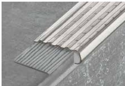
Schlüter-TREP-EK ist ein Treppenprofil aus Edelstahl mit spezieller rutschhemmender Profilierung zur sicheren und optisch ansprechenden Ausgestaltung von Stufenkanten. Es lässt sich nachträglich auf Stufen aus Fliesen oder Natursteinplatten aufkleben. (Produktdatenblatt 3.3)
