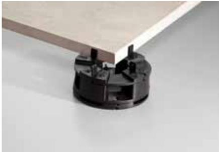
Schlüter-TROBA-LEVEL-PLA 30 sind Höhenadapter für aufgestelzte Plattenbeläge. Ab 50 mm Aufbauhöhe können ein oder mehrere TROBA-LEVEL-PLA 30 Adapter zwischen zwei Schlüter-TROBA-LEVEL-PL 10 Plattenlager eingesetzt werden. TROBA-LEVEL-PLA 30 können bis zu 300 mm Höhe gestapelt werden und sind mit den Plattenlagern TROBA-LEVEL-PLV 60 sowie TROBA-LEVEL-LV 3 kombinierbar. (Produktdatenblatt 7.6)
