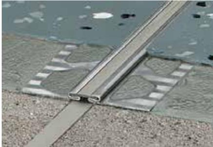
Schlüter-DILEX-EKSB ist ein Bewegungsfugenprofil mit Kantenschutz für Beschichtungen und sonstige dünn-schichtige Bodenbeläge. Es besteht aus seitlichen Befestigungsschenkeln aus Edelstahl, die mit einer nichtauswechselbaren Dehnzone aus weichem Kunststoff verbunden sind. (Produktdatenblatt 4.8)
