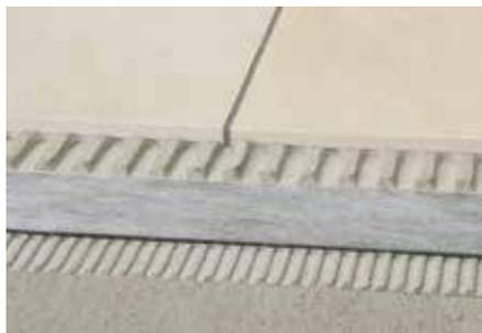
Schlüter-DITRA-SOUND ist eine Schwerfolie auf Polyethylenbasis, die vorder- und rückseitig mit einem Vlies zur Verankerung im Fliesenkleber versehen ist. DITRA-SOUND dient in Verbindung mit Fliesenbelägen als Verbund-Trittschalldämmung. (Produktdatenblatt 6.3)
