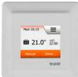
Schlüter-DITRA-HEAT-E-R ist ein Temperaturregler für die Regelung der mit Schlüter-DITRA-HEAT-E elektrisch beheizten Boden- und Wandbeläge. Die Bedienung erfolgt über das 2" (5,1 cm) große Touchscreen-Display. Der Temperaturregler steuert wahlweise die Oberflächen- oder Raumtemperatur nach einem Zeitplan. Ein Reservefühler ist im Lieferumfang enthalten. (Produktdatenblatt 6.4)
