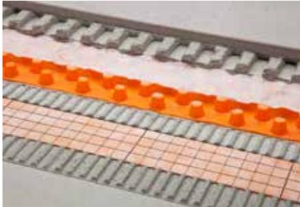
Schlüter-DITRA-DRAIN 8 ist eine formstabile Polyethylenfolie mit einer einseitig ausgeformten speziellen Noppenstruktur. Sie ist auf der Unterseite mit einem Vlies zur Verankerung im Fliesenkleber und an der Oberseite mit einem speziellen Filtervlies ausgestattet. Schlüter-DITRA-DRAIN 8 ist ein universeller Untergrund für Fliesenbeläge als Entkopplungsschicht und dauerhaft wirksame kapillarpassive Verbunddrainage. (Produktdatenblatt 6.2)
