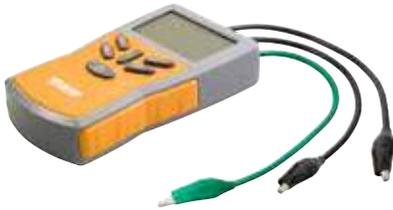
Schlüter-DITRA-HEAT-E-CT ist ein Testgerät zur Messung und Überprüfung des Widerstandes der elektrischen Heizkabel Schlüter-DITRA-HEAT-E-HK sowie der den Schlüter-DITRA-HEAT-E Reglern beigefügten Fernfühler. Während der gesamten Einbauphase überwacht das Gerät den Widerstand der Heizkabel. Im Schadensfall wird der Verarbeiter durch ein akustisches Signal alarmiert.
