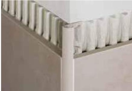
Schlüter-RODEC-TS ist ein symmetrisch gerundetes Profil mit Fugensteg für Wandaußenecken und Belagsabschlüsse aus Aluminium mit einer speziell strukturierten Beschichtung. Durch den Fugensteg wird eine definierte Fugenkammer zur Fliese vorgegeben.
