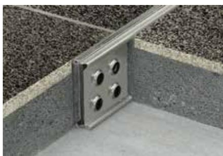
Schlüter-DILEX-EMP ist ein Bewegungsfugenprofil aus Edelstahl für die Mörtelbettverlegung, welches durch eine Nut-/Federverbindung horizontale Bewegungen aufnehmen kann.
