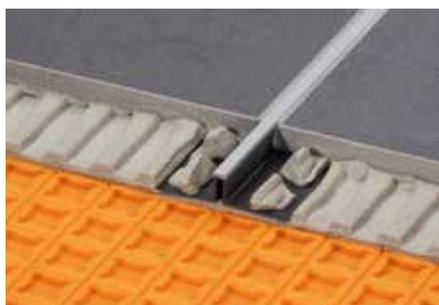
Schlüter-DILEX-BWS ist ein Bewegungsfugenprofil mit Seitenteilen aus Hart-PVC-Regenerat. Die Bewegungszone besteht aus weichem Kunststoff und bildet die 5 mm breite Sichtfläche.
