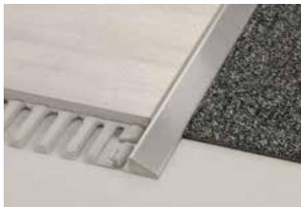
Schlüter-RENO-U ist ein Profil zum stufenlosen Übergang verschieden hoher Bodenbeläge. Durch den Fugensteg wird eine definierte Fugenkammer zur Fliese vorgegeben. Schlüter-RENO-EU, -EBU und -MU haben keinen Fugensteg.
