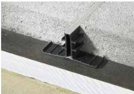
Schlüter-DILEX-EP ist ein Bewegungsfugenprofil für die Verarbeitung in schwimmenden oder Verbund-Estrichen. Die Seitenteile bestehen aus Hart-PVC mit einer unteren und oberen Bewegungszone aus grauem Weich-Kunststoff.
