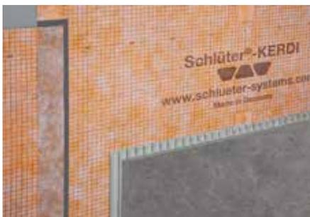
Schlüter-KERDI ist eine Abdichtungsbahn aus Polyethylen, die zur Verankerung im Fliesenkleber beidseitig mit Vliesmaterial versehen ist. Sie eignet sich besonders für Abdichtungen im Außenbereich unter Flächendrainagen mit Schlüter-TROBA-PLUS oder Verbunddrainagen mit Schlüter-DITRA-DRAIN. (Produktdatenblatt 8.1)
