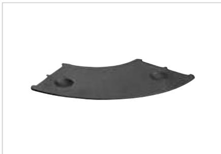
Schlüter-TROBA-LEVEL-AP 1 Ausgleichsplättchen dienen zur Feinjustierung der zu verlegenden Platten in verschiedenen Gefällesituationen. Abweichende Plattendicken, Unebenheiten des Untergrundes oder leichtes Gefälle können bis zu 10 mm pro Plattenecke ausgeglichen werden. (Produktdatenblatt 7.6)
