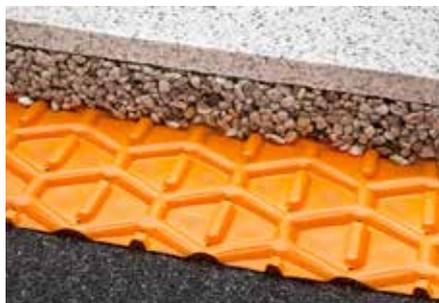
Schlüter-TROBA ist eine Trenn- und Drainageschicht über horizontalen Abdichtungen unter Estrich- oder Kiesauflagen. Sie besteht aus einer druckstabilen Polyethylen-Noppenfolie mit Löchern zu den Drainagekanälen. Zur Fliesenverlegung auf Estrichschichten muss als Entkopplung und Abdichtung Schlüter-DITRA eingebaut werden.
