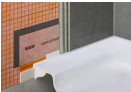
Schlüter-KERDI-TS ist ein Set zur sicheren Andichtung von Einbauteilen wie z. B. Bade- und Duschwannen aus Stahl-Emaile, Acryl oder Mineralguss (gemäß DIN 18534-1) an das Schlüter-KERDI Abdichtungssystem. Es beinhaltet ein Anschluss-Dichtband aus Polyethylen mit beidseitigem Vliesgewebe und selbstklebendem Schalldämmstreifen sowie Installationsmaterial. (Produktdatenblatt 8.9)
