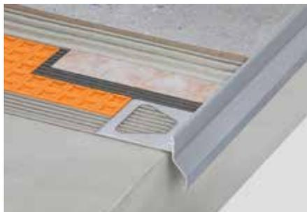
Schlüter-BARA-RKK ist ein T-förmiges Abschlussprofil mit kurzer Tropfkante zur Verlegung auf einen fertigen Gefälleestrich. Es ist für einen Konstruktionsaufbau mit der Verbundabdichtung Schlüter-DITRA ausgelegt. Durch die geschlossene Aufkantung erhält man einen sauberen Fliesenabschluss.
