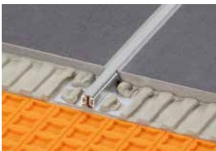
Schlüter-DILEX-AKWS ist ein Bewegungsfugenprofil mit seitlichen Befestigungsschenkeln aus Aluminium, die mit einer Bewegungszone aus weichem Kunststoff verbunden sind. (Produktdatenblatt 4.18)
