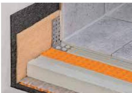
Schlüter-BARA-ESOT ist ein Sockelträgerprofil aus Edelstahl, welches eingesetzt werden kann, wenn für Sockelfliesen kein tragfähiger Untergrund vorhanden ist. (Produktdatenblatt 5.1)
