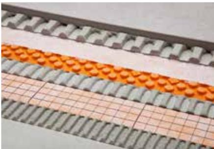
Schlüter-DITRA-DRAIN 4 ist eine formstabile Polyethylenfolie mit einer einseitig ausgeformten speziellen Noppenstruktur und einem an der Oberseite aufkaschierten Filtervlies aus Polypropylen. Sie ist ein universeller Untergrund für Fliesenbeläge als Entkopplungsschicht und dauerhaft wirksame kapillarpassive Verbunddrainage. (Produktdatenblatt 6.2)
