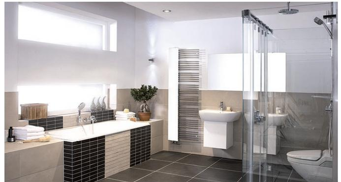
Abb. 1 – Beanspruchungsklasse A0 – Mäßige Beanspruchung. (Bauaufsichtlich nicht geregelter Anwendungsbereich).
